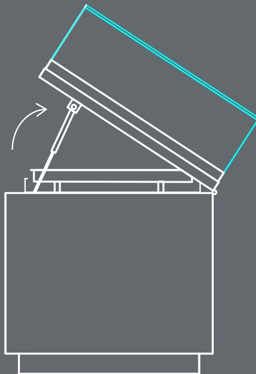
L'accesso al vano espositivo è possibile anche da un solo operatore grazie all'utilizzo di molle a gas che rendono agevoli le fasi di apertura e chiusura. Il mantenimento della campana in posizione aperta consente all'allestitore di poter lavorare sulla totalità del piano espositivo
