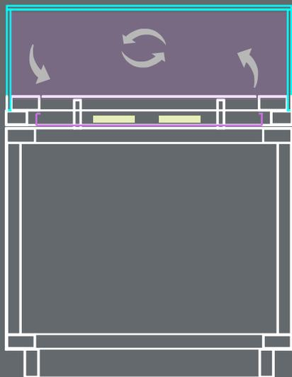
La vetrina consente un controllo passivo dell'umidità grazie all'utilizzo di guarnizioni perimetrali in neoprene e l'impiego di sali igroscopizzanti. Una vasca con pieghe in acciaio zincato collocata sotto il piano espositivo garantisce il completo isolamento del vano espositivo dall'esterno della teca. mantenimento delle condizioni dell'opera
